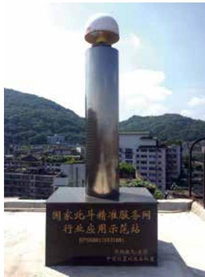
北斗地面差分站（宜宾华润燃气）
